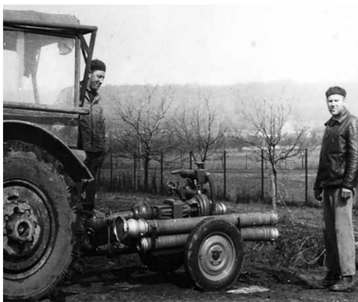
Závěsná dvoukolová stříkačka. Zleva Josef Mynařík a Karel Pospíšil. Zdroj: Štolfova fotokronika
